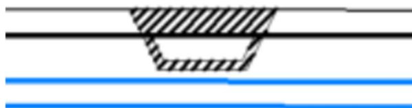
Fig.: Schema geometrico del canale e posizione indicativa della tubazione DN400
